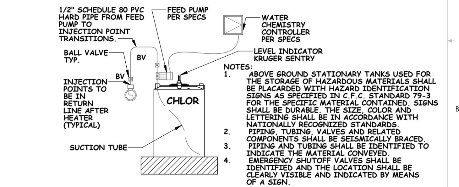
**SODIUM HYPOCHLORITE FEED SCHEMATIC**
