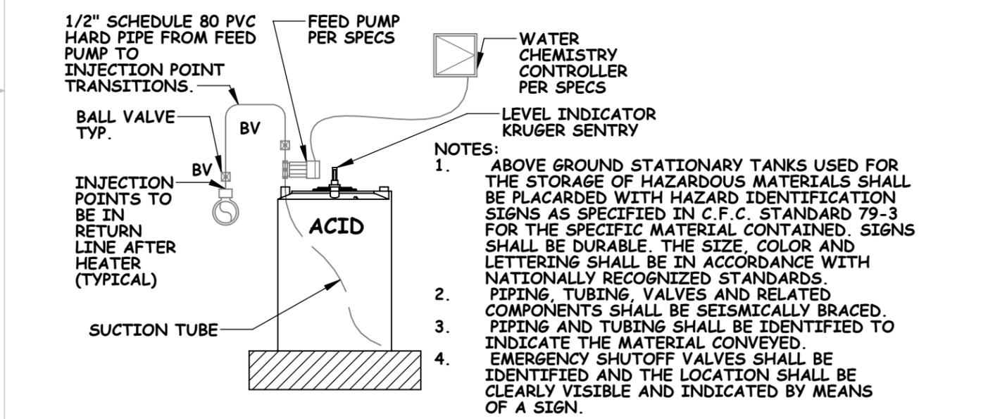
**HYDROCHLORIC ACID FEED SCHEMATIC**
